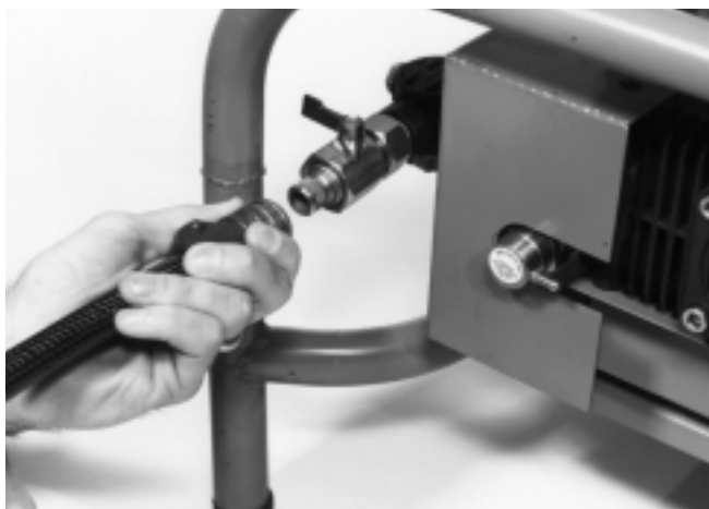
Figure 4 – Branchement du tuyau d'arrivée d'eau sur le dégorgeoir. Fermeture de la vanne d'arrivée (montrée en position fermée).
