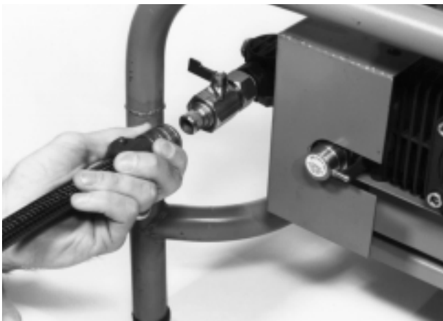
Figura 4 – Conecte la manguera de suministro de agua a la Limpiadora. Cierre la válvula de admisión del suministro (se la muestra en posición CERRADA)
